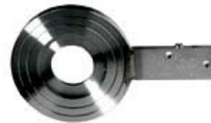
FSS – межфланцевое материал: нерж.сталь (SS316) Ду 15 - 300 мм, устанавливается между двумя фланцами, которые стягиваются болтами друг с другом (сэндвич)
