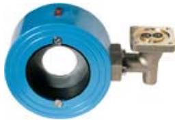
FA - межфланцевое материал: Ду 15-40 мм: медный сплав Ду 50-300 мм: чугун с эпоксидным покрытием, устанавливается между двумя фланцами, которые стягиваются болтами друг с другом (сэндвич)
